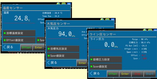
温度センサー・大気圧センサー・ライン圧センサーの校正できます。
