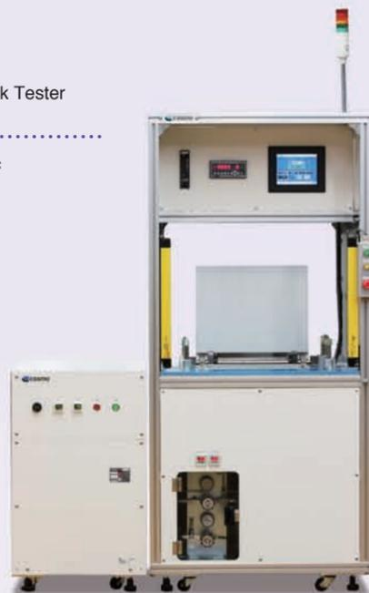
エアリークテストでは検知できない微小な漏れを、ヘリウムガスを使用することで検出ができます。
