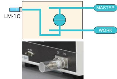
容積変化方式 Volumetric change method
