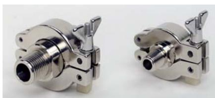
センサの着脱接続用に開発されたクイックフランジカップラです。蝶ねじを締めるあるいは緩めるだけで簡単に着脱ができます。手締めだけで確実な接続とシール性を発揮します。
